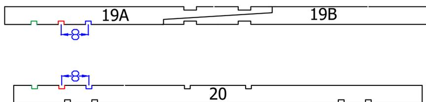
Orientate i pezzi come mostrato. Partendo dal centro delle tacche evidenziate in rosso nel disegno, misurate 8 mm verso destra e create delle nuove tacche utilizzando una lima.
