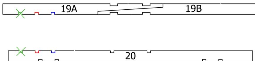
Per le successive operazioni di montaggio ignorate le tacche evidenziate in verde nel disegno. Utilizzate solo quelle evidenziate in rosso e blu.
